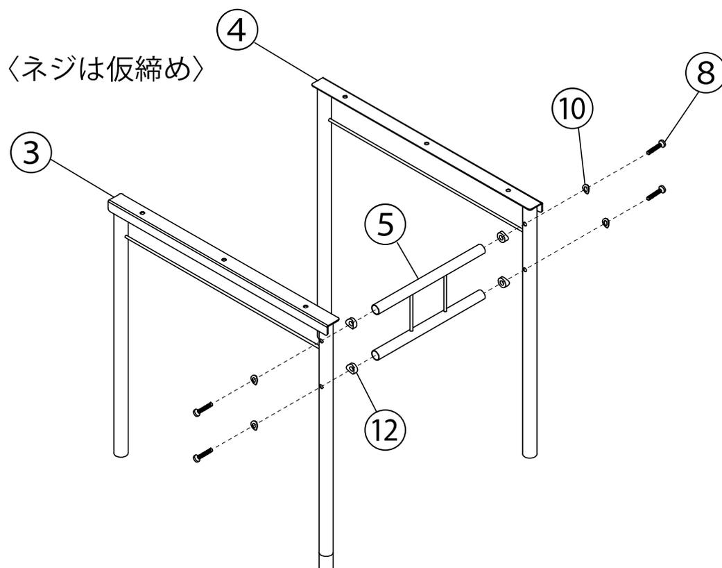
⑩と⑫の部品は③と④のパイプフレームにフィットするように曲面を合わせて取り付けてください。
